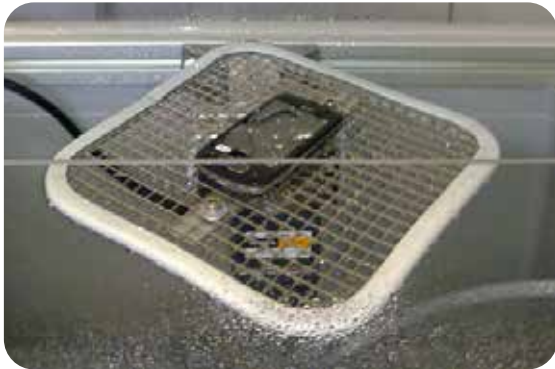
Rakaþol símanna var kannað með sértöku tæki sem líkir eftir rigningu.
